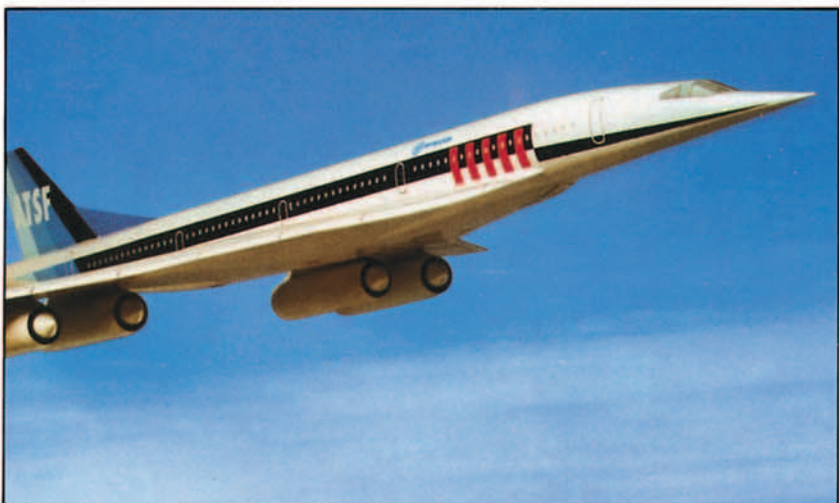
El ATSF (Avión de Transport Supersonique Futur) presentado en maqueta por Aerospatiale. Tendrá una capacidad para 200 pasajeros y un radio de acción de 1.200 km.
