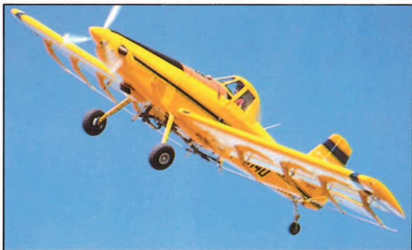
Air Tractor AT 502, con depósito de fluido para aspersión, de 1.900 litros, descargado por 40 boquillas. Está propulsado por un turbohélice PTGA-15-AG.
