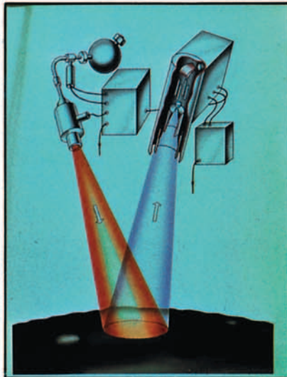
Dibujo del experimento de análisis a distancia de la masa de iones secundarios. Sistema de inyección de iones. Bloque de receptores. Bloque de tratamiento.
