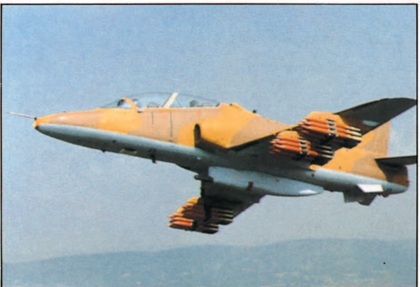
Hawk 60 armado con 36 bombas antipista y un pod cañón Aden bajo el fuselaje.
