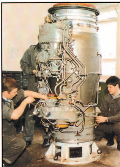
El diseño modular del motor Adour simplifica las tareas de mantenimiento y aumenta la disponibilidad operativa.
