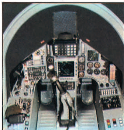
Vista de la cabina delantera del Hawk 100 con la pantalla multimodo y el HUD para presentación de datos al piloto.
