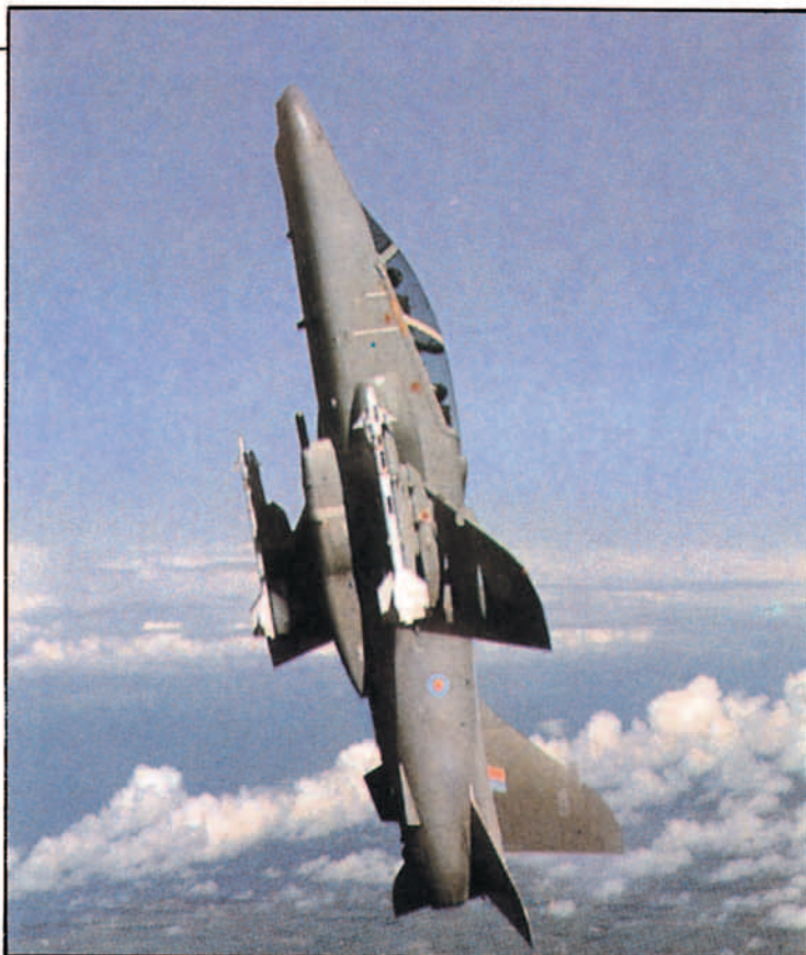
Prototipo de demostración del Hawk 100 subiendo a la vertical, armado con 2 misiles Sidewinder y un cañón Aden.
