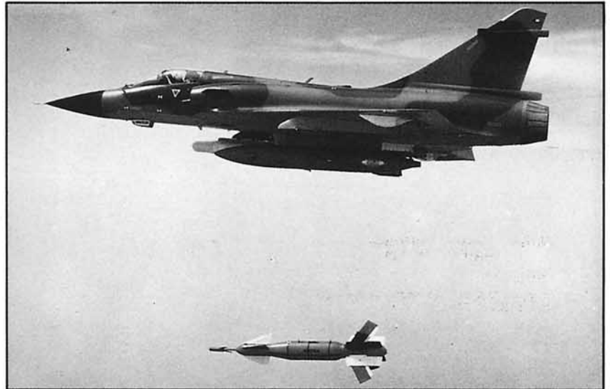
Avión Mirage 2000 francés lanzando una bomba BGL (Bomba de Guiado Láser).
