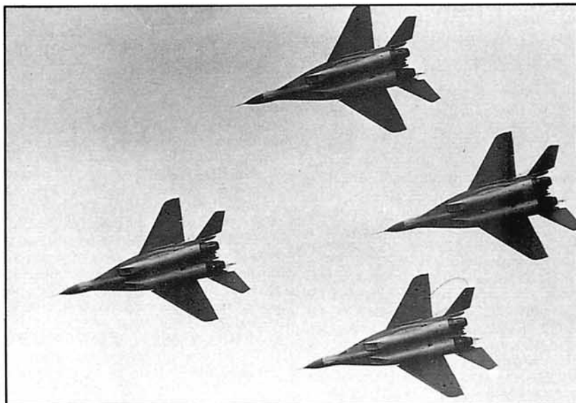
En esta vista inferior puede observarse la peculiar disposición de las góndolas de los motores.
