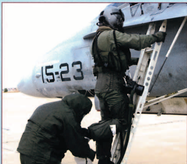
El mecánico retira la cubierta de las botas. De esta manera se introduce una mínima cantidad de contaminante en la cabina.
