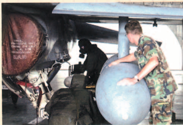
Armeros con traje NBQ montando AIM-7F en un avión. Nótese la intensa vigilancia realizada por el evaluador de TACEVAL (en primer plano).
