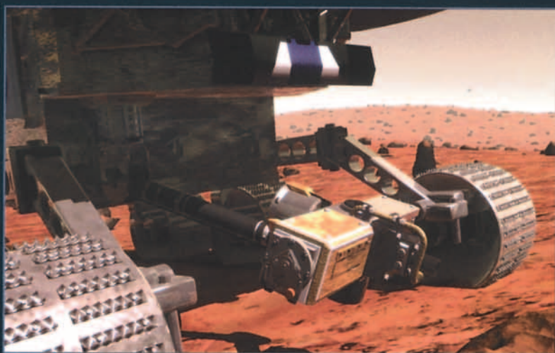
Un detalle del espectrómetro que analizará la composición química de las rocas y el suelo.
