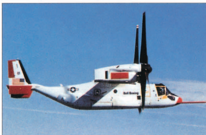
Transición de modo helicóptero a modo avión de uno de los prototipos del V-22.
