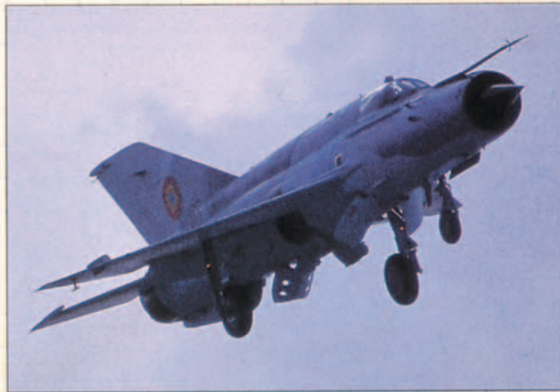
Mig-21 Bis (modernizado bajo la denominación Lancer III) de origen rumano pero con un piloto israelí a los mandos. Nótese la presencia de hasta tres frenos aerodinámicos desplegados.
