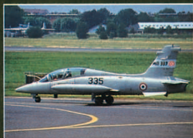
Aermacchi 539 CD con sonda de reabastecimiento en vuelo entre otras novedades.
