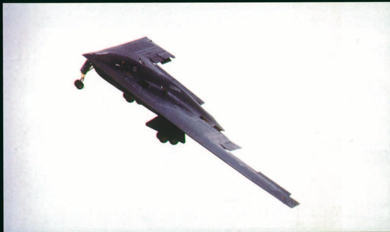
*Las formas del B-2, un ala volante químicamente pura, son un concepto recurrente a la hora de hablar del diseño de los UCAV. Northrop trabaja en el programa UCAV ATD sobre una aeronave de gran parecido con su B-2.*
