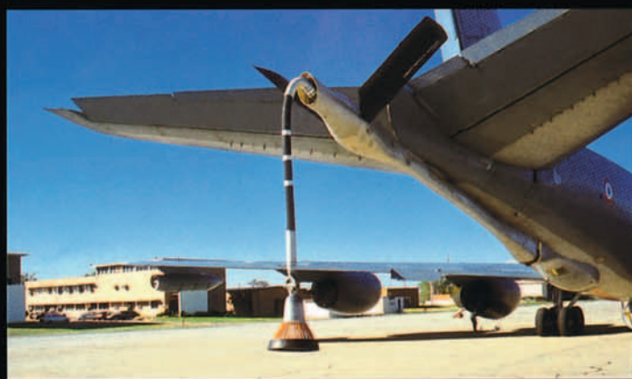
El BDA ("Boom to Drogue Adapter") es el diseño que necesitaban los cisternas procedentes de la USAF para poder operar con receptores dotados de sonda. En la imagen, un KC-135 francés con el BDA.
