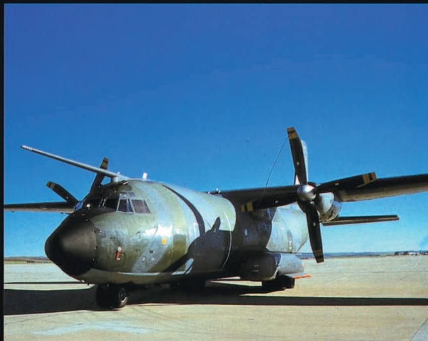
La sonda en forma de lanza del cisterna C-160 "Transal" le capacita también como receptor. Este será un requisito de los futuros aviones de transporte como el FLA o el C-130J.
