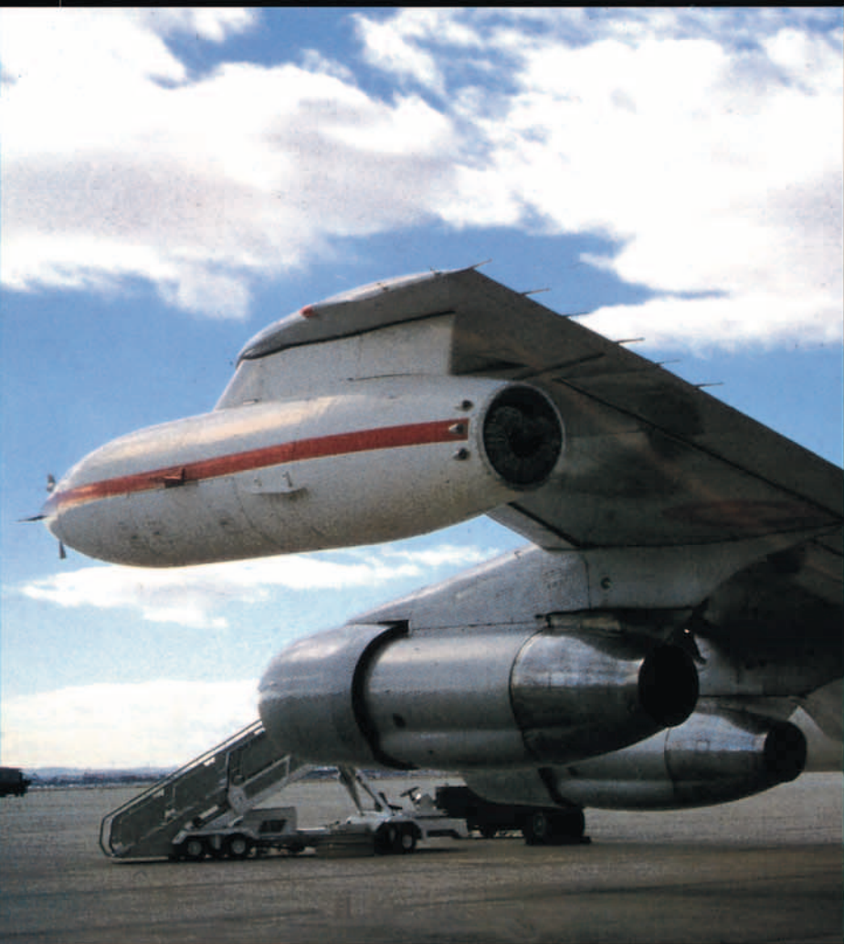
Detalle del pod de reabastecimiento "Sargent Fletcher" del Boeing 707, del que se desplega en vuelo el binomino manguera/cesta.
