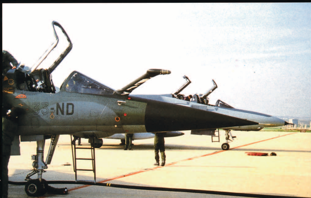
El Mirage F-1 está dotado, al igual que el CR-12, de sonda fija de reabastecimiento. En la imagen en F-1 CR de la Base Aérea de Reims (Francia) durante un intercambio OTAN en Torrejón.
