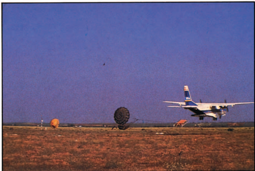
Ensayos de lanzamiento de cargas a baja cota con extracción por paracaídas (LAPES) en Salamanca.
