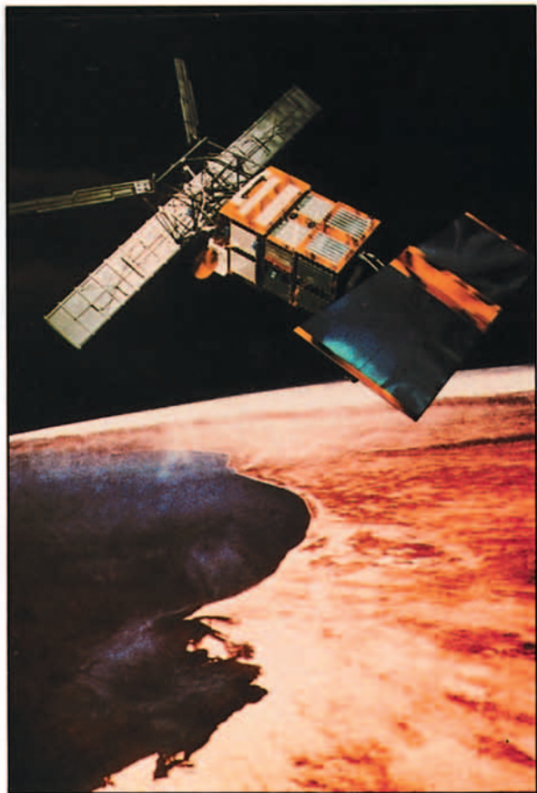
El satélite europeo de teledetección ERS-1 está destinado al estudio de los océanos, zonas costeras y glaciares. Tiene fines científicos y de aplicaciones. El lanzamiento por el Ariane-4 está previsto para 1989-1990.
