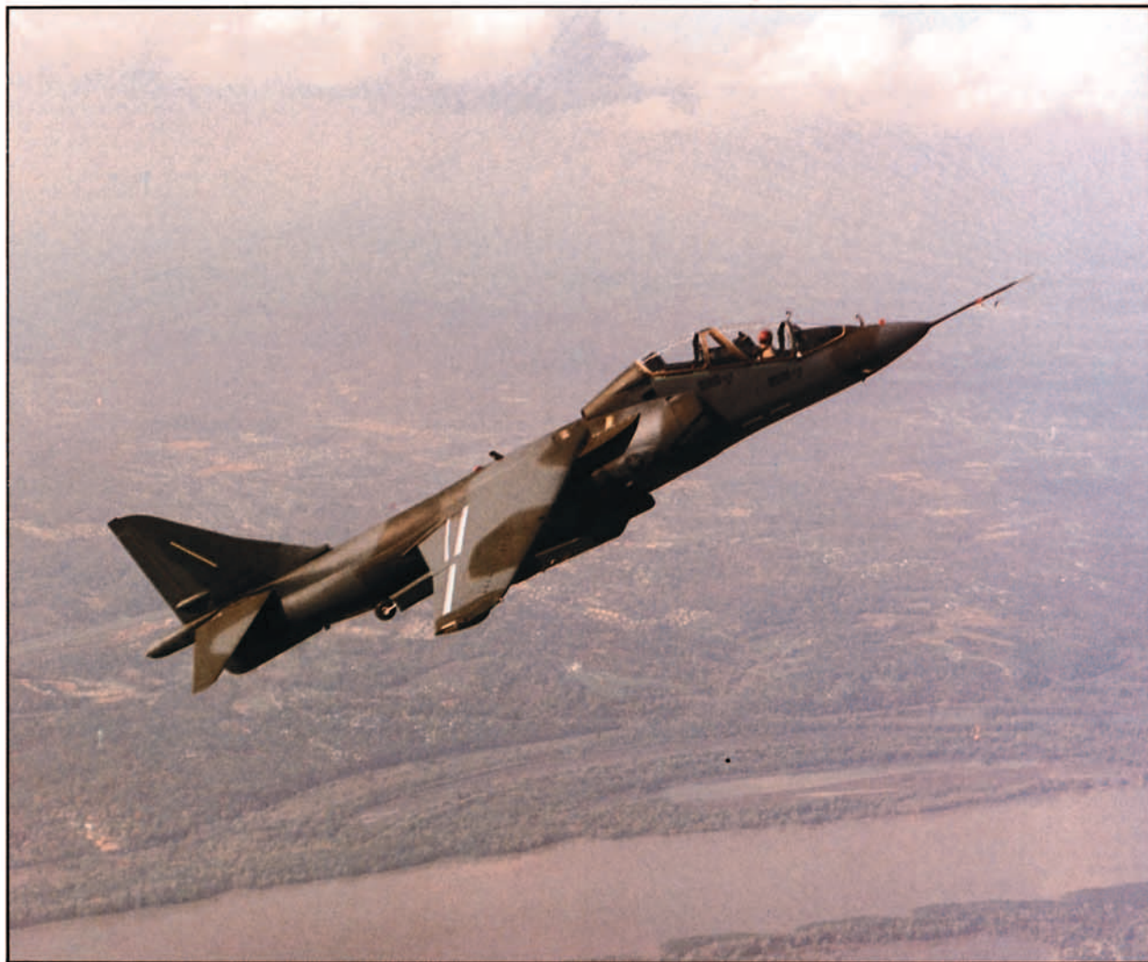
Fotografía obtenida durante el primer vuelo sobre el río Missouri del TAV-8B, versión biplaza del AV-8B Harrier II de McDonnell Douglas. En este avión de entrenamiento se ha alargado el fuselaje en su parte delantera para albergar la segunda cabina y se ha agrandado también el plano de deriva para que conserve sus características de vuelo.
