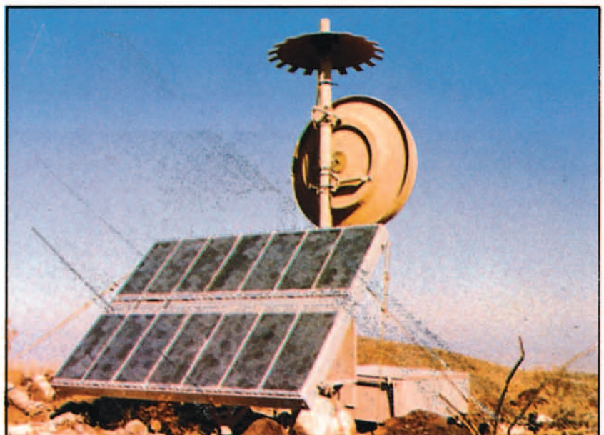
Estaciones principal y remota del subsistema de instrumentación y seguimiento (TIS). Esta última alimentada por placas de energía solar.
