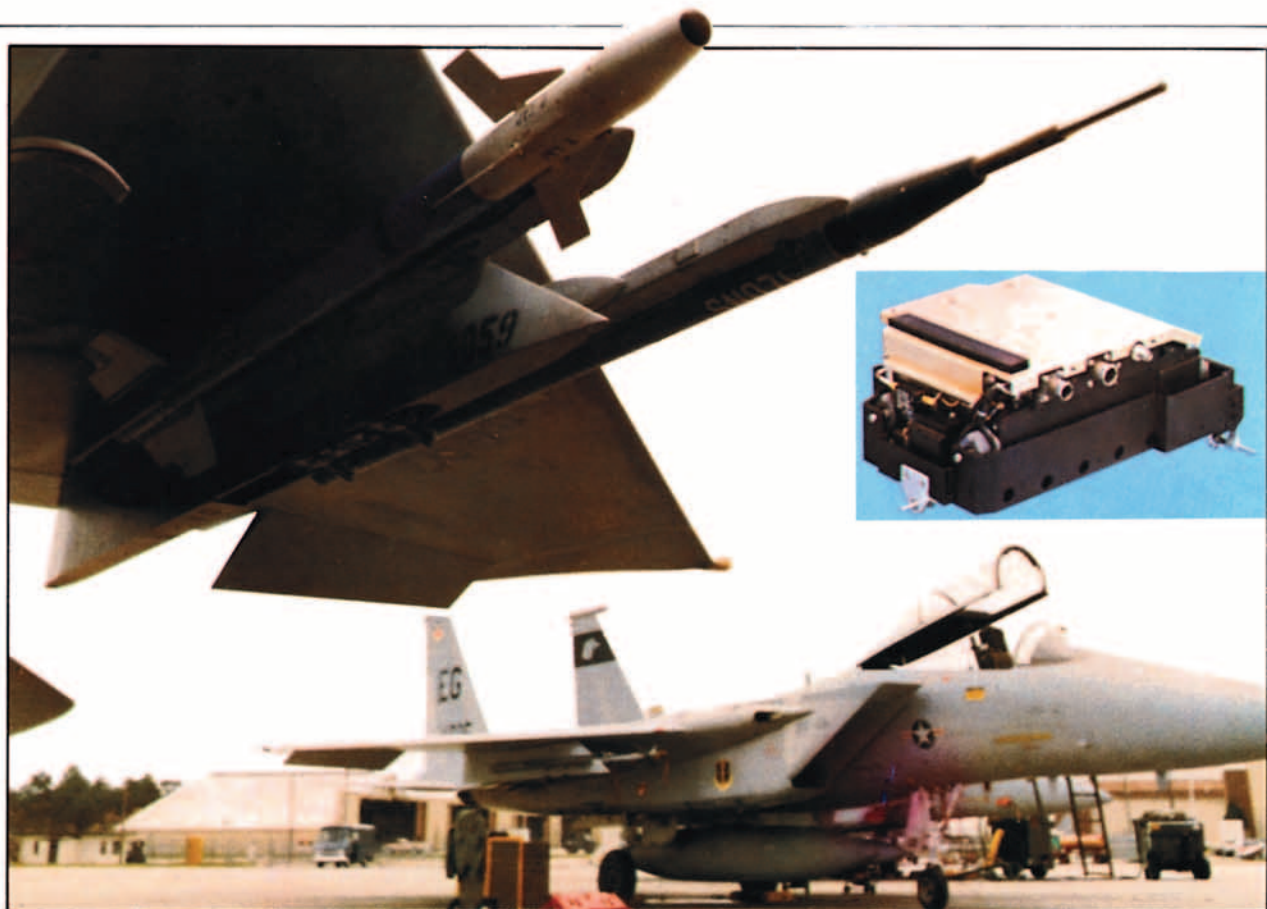
Montaje del subsistema de instrumentación de a bordo (AIS) en un F 15 de la USAF. Obsérvese la similitud con el misil AIM9 L situado a su lado. En el recuadro, el AIS interno conectado al sistema de barra colectiva de datos múltiples del F/A 18.
