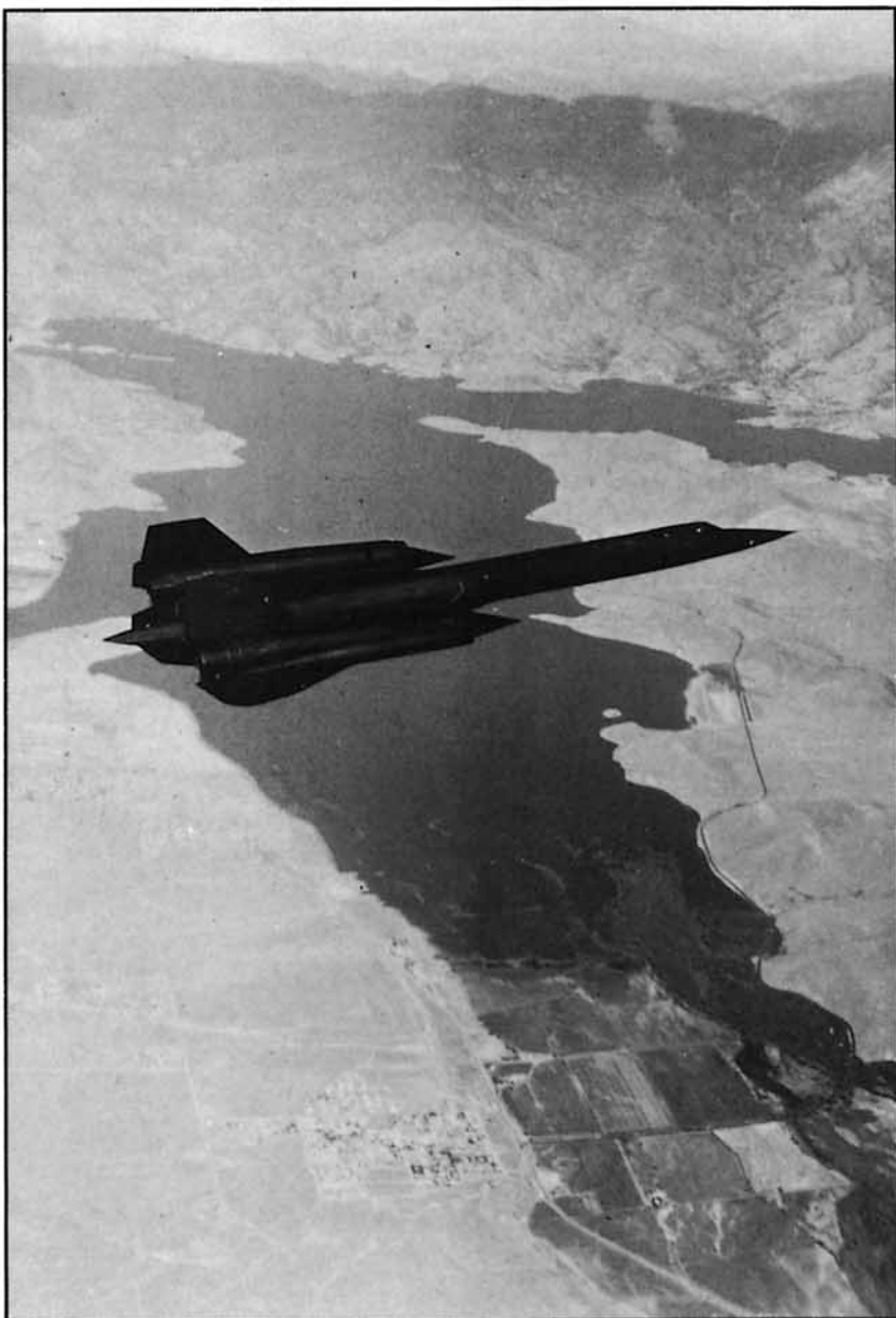
El SR-71 fue el primer avión diseñado y desarrollado con algunas de las tecnologías indetectables, tales como evitar superficies rectas y utilizar materiales absorbentes de la radiación, RAM.
