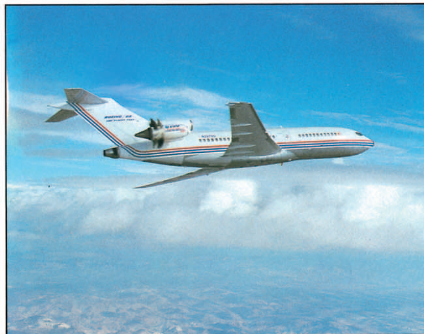
Veinte de agosto de 1986. Primer vuelo de un UDF de GENERAL ELECTRIC, en un 727-100 de BOEING.
