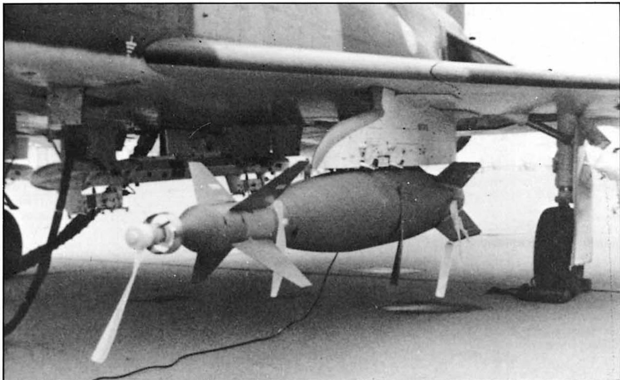
Bomba GBU-10/B montada en un F4C "Phantom".
