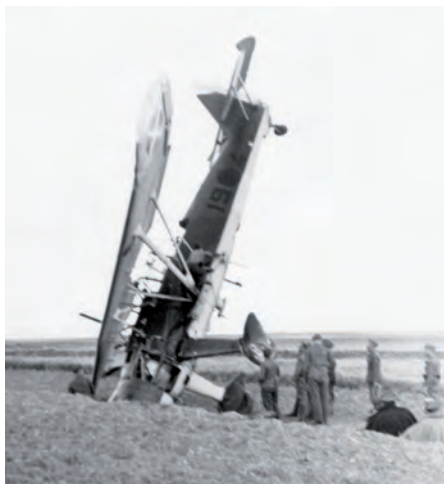
La vida operativa del 19-4 fue corta. El 23 de marzo de 1939, sufrió una avería en el motor en Toledo. Una pareja de guardias civiles y siete mecánicos de la Legión Cóndor observan el avión accidentado, con las palas de la hélice torcidas. Al parecer, el borde marginal izquierdo del ala impactó en tierra antes de finalizar su recorrido en la zanja.
