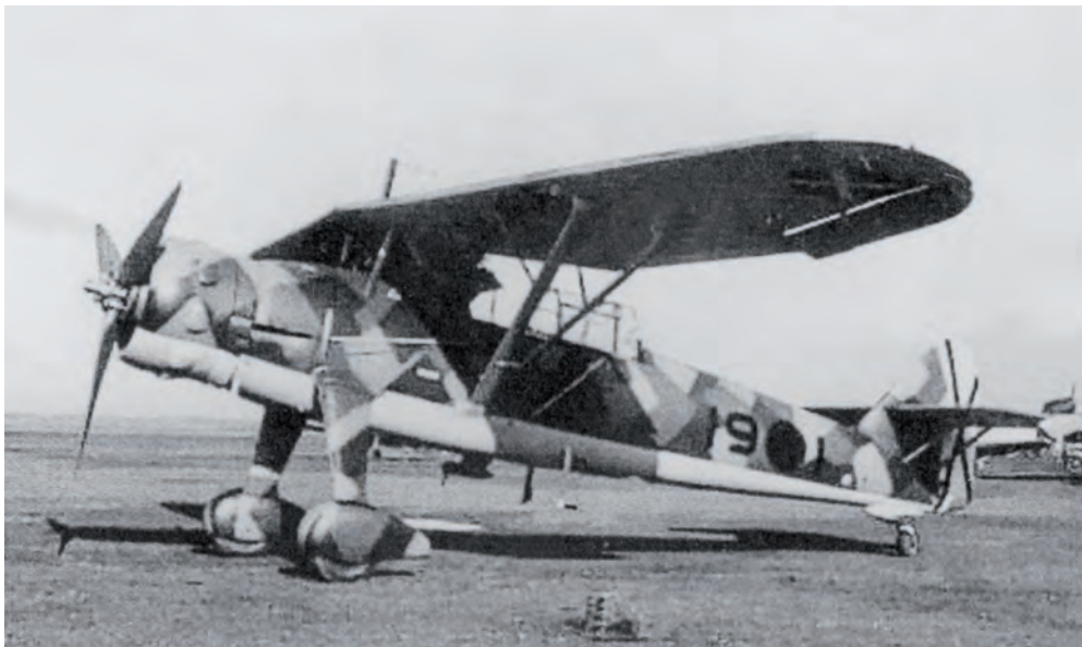
Henschel Hs 126A-1 19-1 asignado a la A./88 H-Kette. Una vez completado su montaje en las instalaciones del aeródromo de La Virgen del Camino (León), deja ver su camuflaje tres tonos aplicado en origen, utilizando las tonalidades RLM 40 o 52, RLM 62 y RLM 63 e, igualmente, RLM 65.
