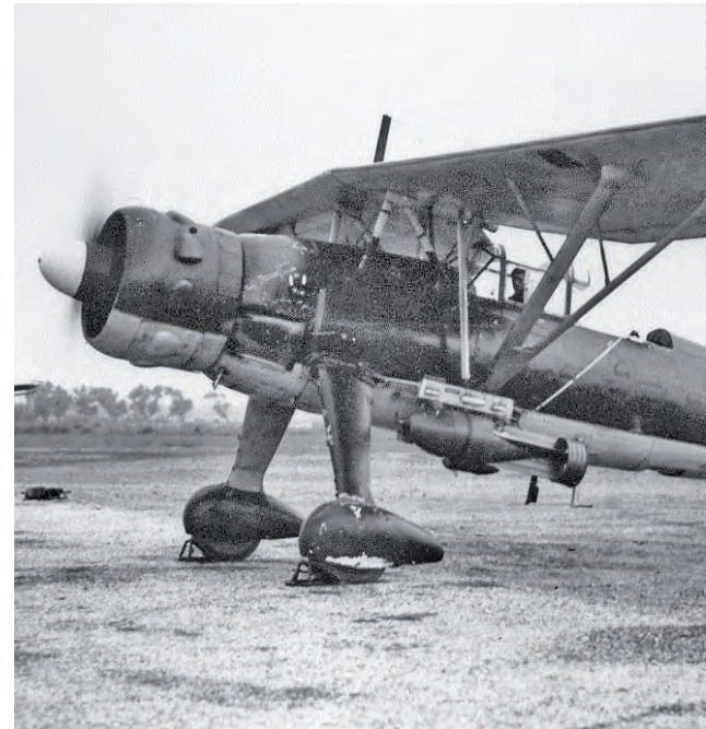
Armado con una bomba de 50 kg de origen italiano, el Hs 126 19-7 se nos muestra en una imagen datada oficialmente el 3 de mayo de 1940. El intenso uso en operaciones ha provocado que la pintura salte en el carenado del tren de aterrizaje. Observar igualmente que todavía conserva el Teufel, la insignia de su antigua unidad de destino. A la izquierda se distingue una porción de ala perteneciente a un Ju 52. (1828(1)2ª IHCA)
