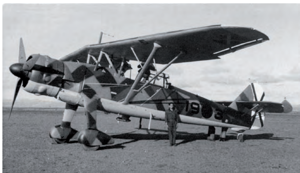
El Hs 126 19-3 luce un aspecto externo prácticamente nuevo. La fotografía muestra perfectamente el esquema de camuflaje tres tonos, que se extiende igualmente a la porción interna de la pata del tren de aterrizaje y el carenado de las ruedas.
