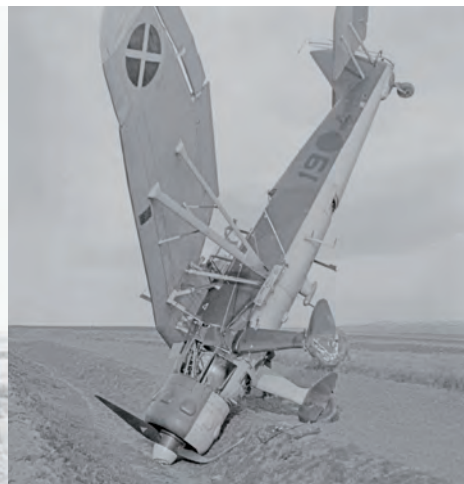
La vida operativa del 19-4 fue corta. El 23 de marzo de 1939, sufrió una avería en el motor en Toledo. Una pareja de guardias civiles y siete mecánicos de la Legión Cóndor observan el avión accidentado, con las palas de la hélice torcidas. Al parecer, el borde marginal izquierdo del ala impactó en tierra antes de finalizar su recorrido en la zanja.
