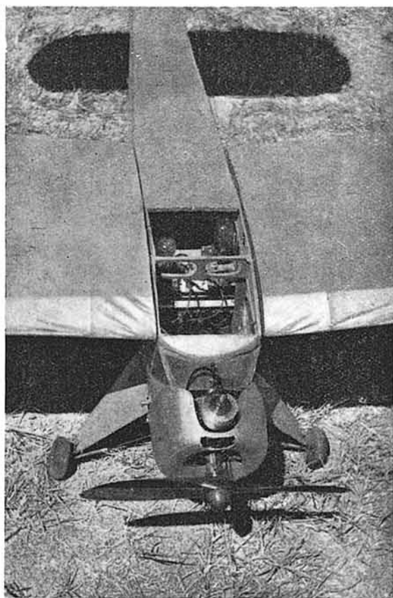
El "E. C. 2", dirigido por radio. Se ven claramente las lámparas del receptor y las instalaciones auxiliares.
