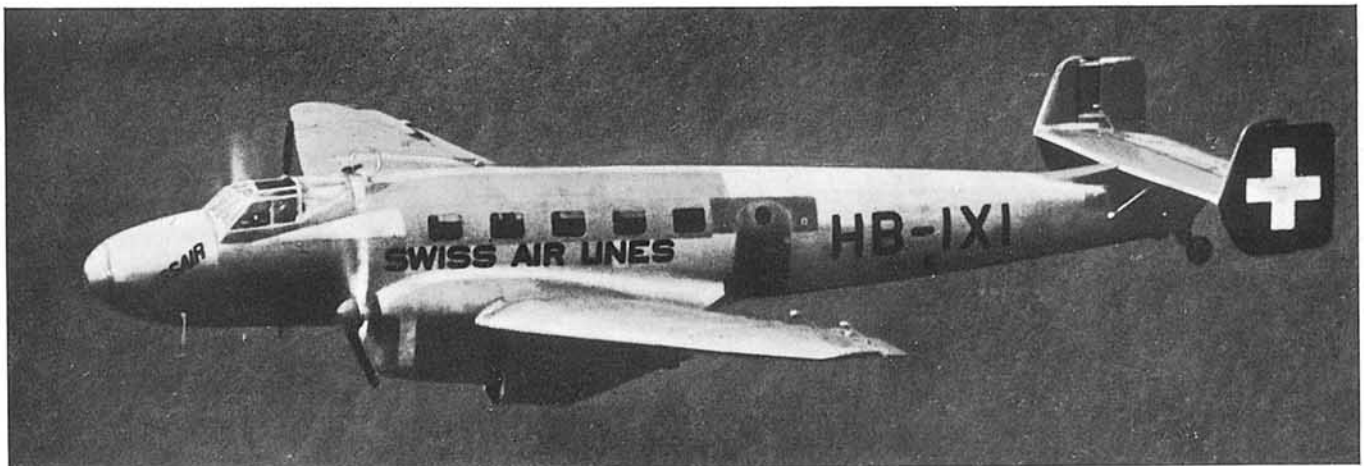
La compañía suiza Swissair ha adquirido para sus servicios un avión Junkers Ju. 86 , provisto de dos motores Junkers Jumo de aceite pesado. El avión en vuelo sobre los bosques alpinos.
