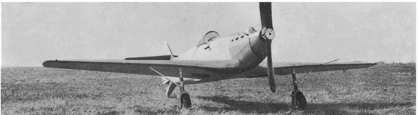
Monoplaza-cañón de caza *Nieuport 160*. Ala baja cantilever, alerones de curvatura, tren eclipsable y cabina cerrada. Además de las dos ametralladoras fijas en el borde de ataque, lleva el motor-cañón *Hispano-Suiza 12 Xcrs*, sobrealimentado, enfriado por agua, previsto para hélice tripala de paso variable en vuelo. Aunque las características y performances son secretas, se le supone una velocidad, a 4.000 metros, de 440 kilómetros-hora con el motor nombrado y de 485 con el motor *12 Y*.
