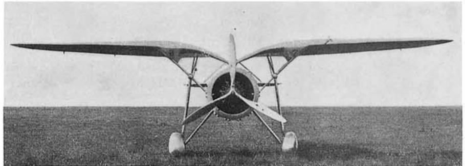
Monoplaza de caza multicañón *Loire 46*. Ala alta (de gaviota) semicantilever. Carlinga abierta. Lleva dos cañones *Oerlikon* carenados en las uniones de los montantes exteriores con el ala, de 20 milímetros de calibre. Pesa 1.360 kilogramos vacío y 1.960 cargado. Velocidad máxima, 400 kilómetros-hora a 4.150 metros de altura. Motor *Gnome-Rhône K-14 e s*, sobrealimentado, de 945 cv.
