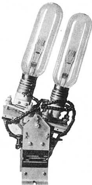
Fig. 5. — Dispositivo automático para recambio de lámparas, que lleva montado en su interior el faro de posición.
