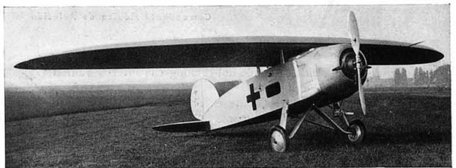
Avión sanitario Albert A-11, monoplano, de ala alta cantilever, de madera, motor Salmson de 120 cv. La cámara sanitaria lleva una puerta lateral que abarca toda su longitud y permite la entrada de la camilla sin molestia para el enfermo.
