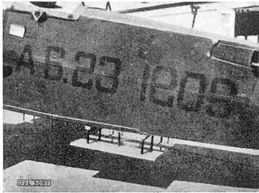
FIG. 19. — Disposición de las placas del condensador para la determinación de la altura, según el método basado en la capacidad.
