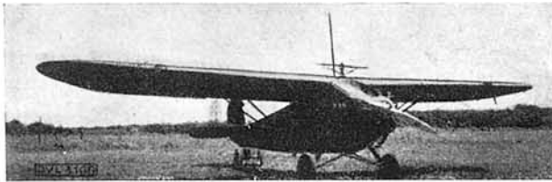
FIG. 22. — Receptor con dipolo horizontal para el procedimiento de la trayectoria de planeo y con antena vertical para el procedimiento del rayo-guía.
