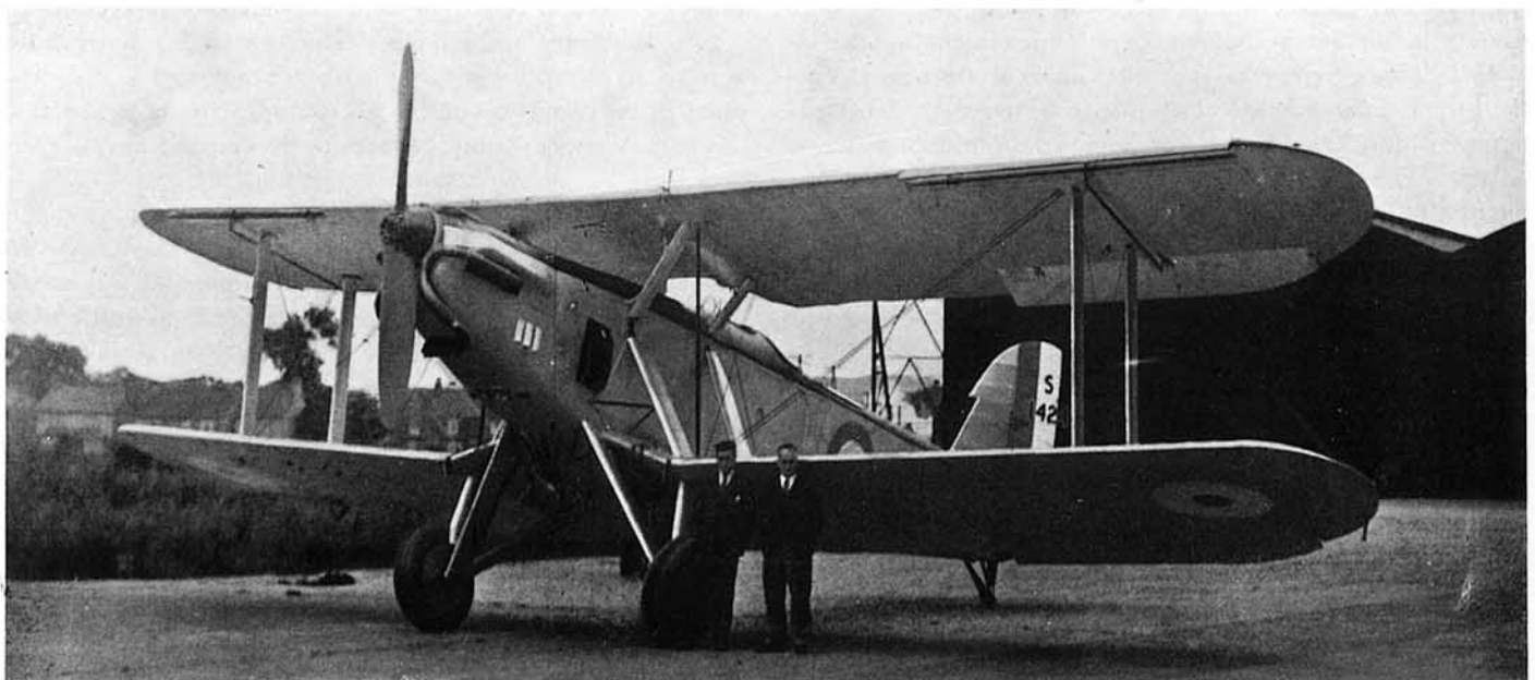
El Blackburn «Ripon» III. A, con motor Napier «Lion» que equipa cinco unidades torpederas de la Fleet Air Arm británica.
