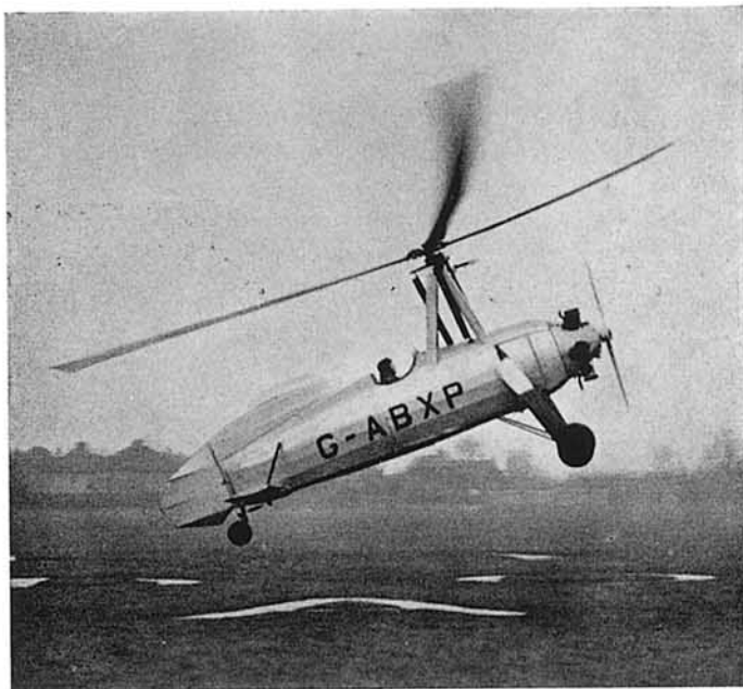
Autogiro con mando sobre el rotor en prueba de vuelo horizontal a velocidad mínima de 25 kilómetros por hora.
