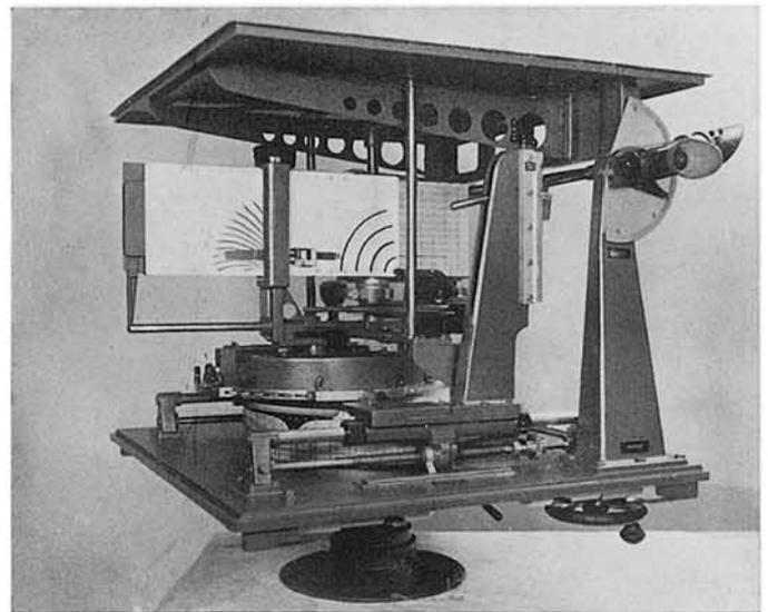
Predictor de tiro «Berkog-7». Mucho más sencillo y de menos precisión que el «B-4». Tiene el mismo fundamento y lleva montada aparte la base telemétrica que determina la altura del avión, que no figura en la fotografía.
