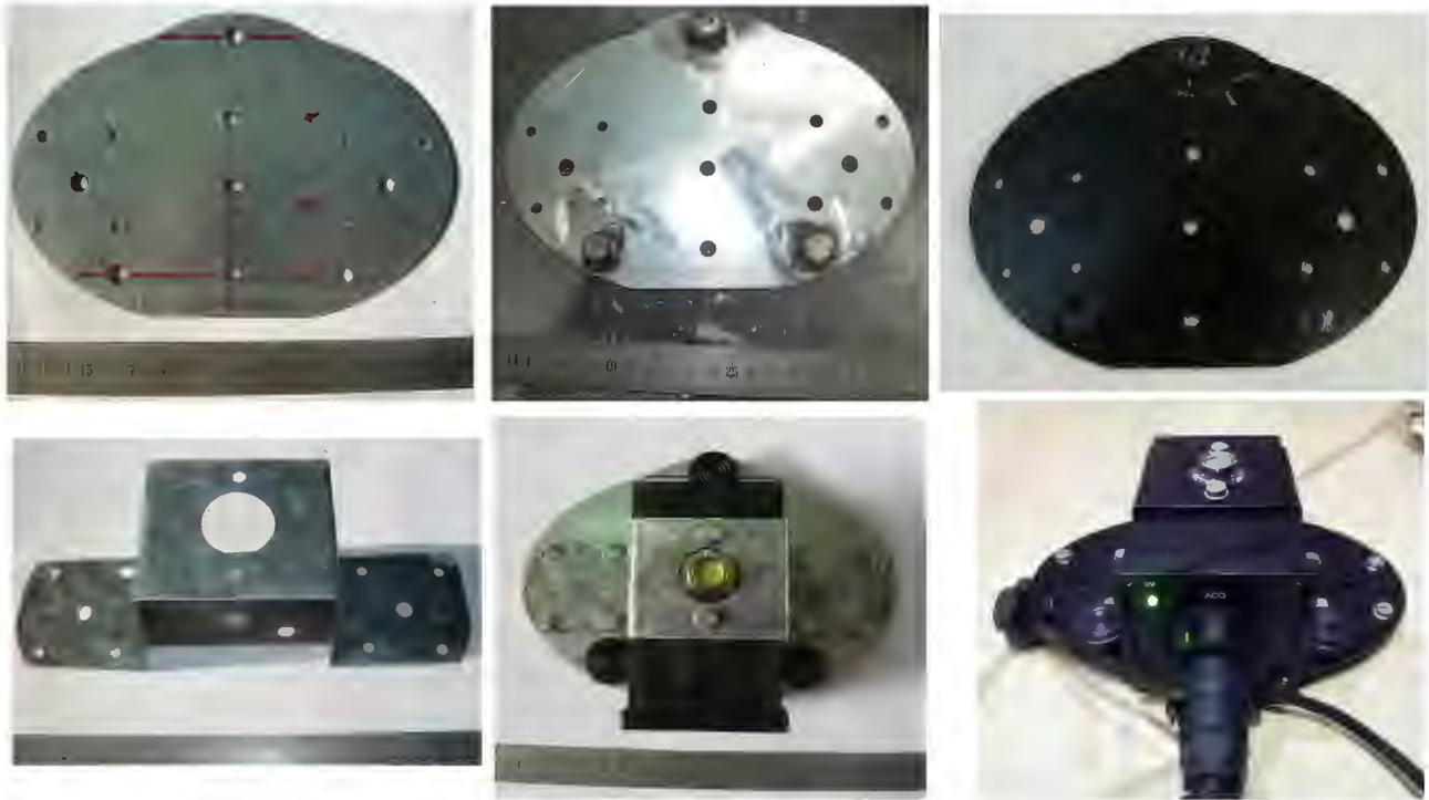
Figura 5.8: Composición con fotografías de las distintas fases de fabricación de la plataforma niveladora y su posterior integración con el sistema.
