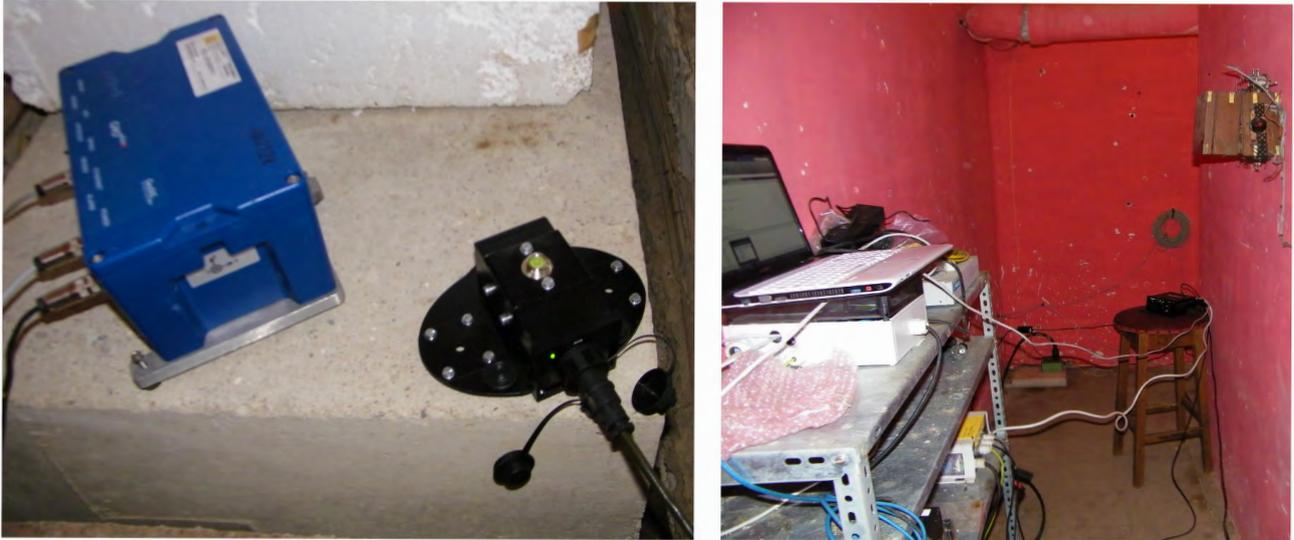
Figura 6.1: A la izquierda, el módulo de telemetría junto a un acelerómetro del Instituto Geográfico Nacional (IGN), ubicado en la estación SFS (San Fernando) de la red WM. A la derecha, perspectiva de uno de los pasillos de la estación con el prototipo Pi-EEWS al fondo.
