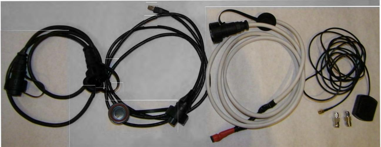
Figura 5.12: Cableado externo. De izquierda a derecha, cableado de interconexión del módulo de instrumentación con el principal, latiguillo con conector RJ45 macho, cable para alimentación, y cableado RG174 y antena GPS, junto con adaptadores SMA a TNC y BNC.
