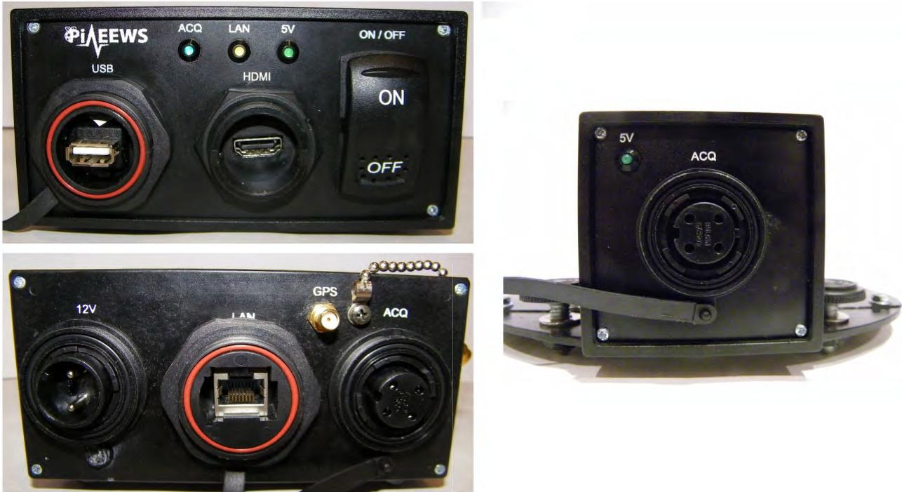
Figura 5.11: Detalle de los conectores de panel de los módulos hardware. Arriba a la izquierda el panel delantero del módulo principal con los conectores USB y HDMI. Abajo a la izquierda, el panel trasero del módulo principal con la toma de alimentación, la toma de red, y la toma para el módulo de instrumentación. A la derecha, el panel delantero del módulo de instrumentación.
