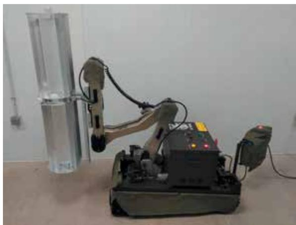
Figura 5. Bastidor portalámparas sobre robot EOD Avenger.
