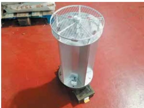
Figura 4. Bastidor portalámparas sobre robot EOD Teodor.
