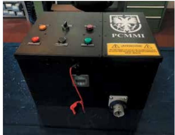
Figura 7. Caja de control y alimentación sobre robot EOD Avenger.
