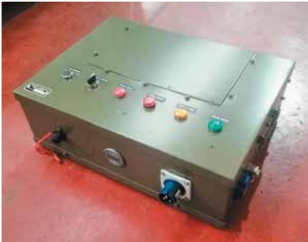
Figura 6. Caja de control y alimentación sobre robot EOD Teodor.
