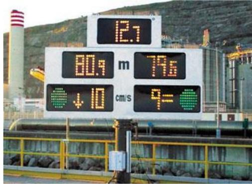
Figura 4. Monitorización atraque (Fuente: www.prosertek.com)
