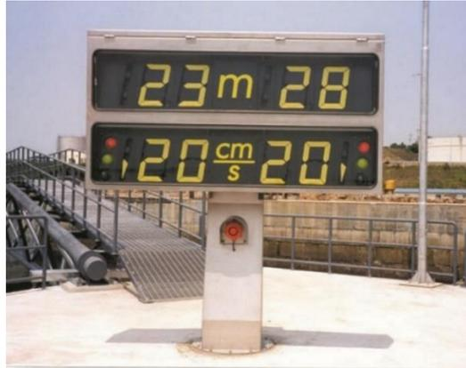
**Figura 2.** Paneles del DAM indicando distancia al muelle y velocidades en proa y popa del buque
