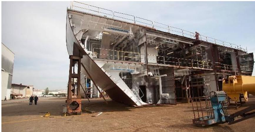
Figura 1. Bloque de un buque en un astillero de Navantia. <www.abc.com>
