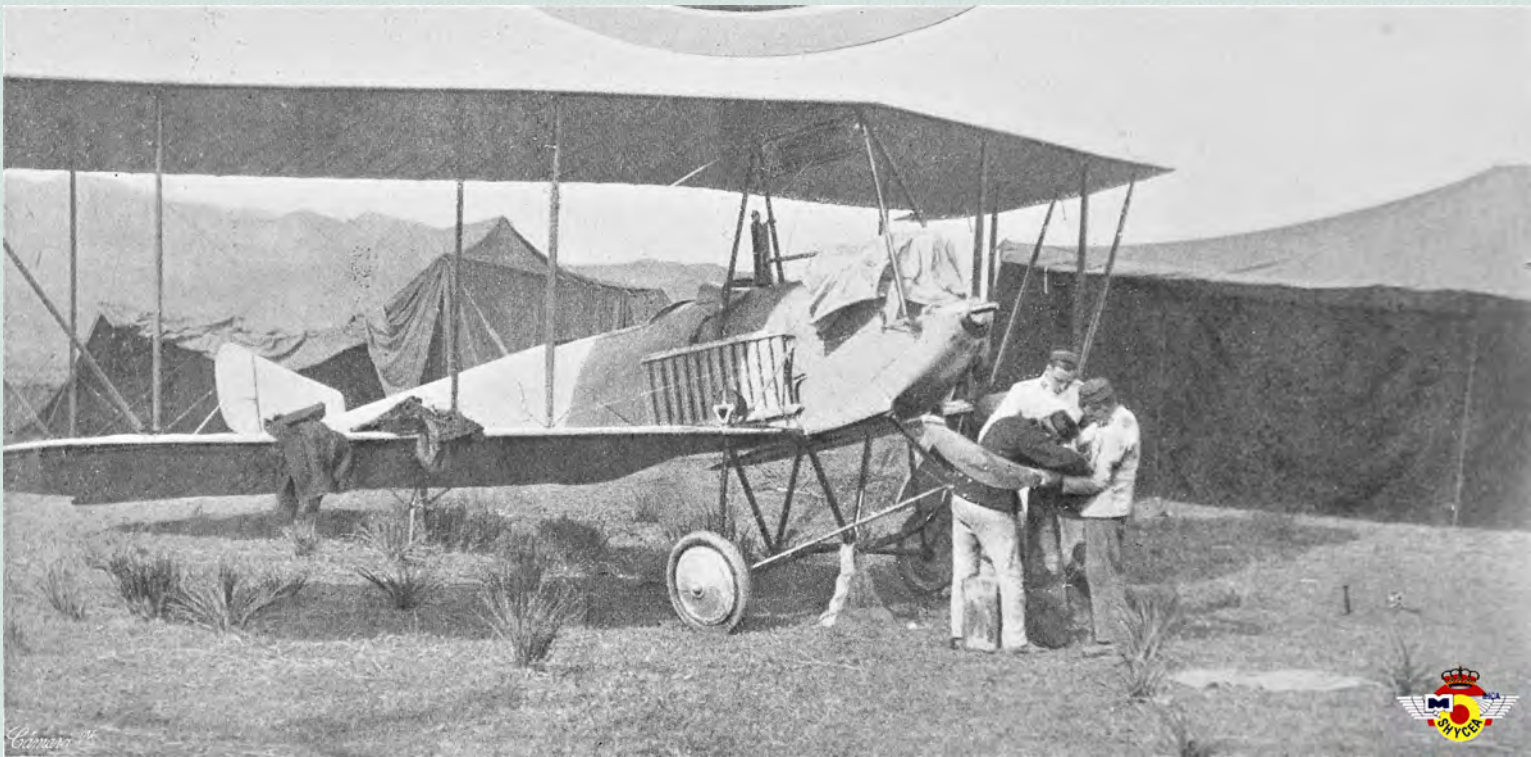
El infante Alfonso reparando una avería en el campo de aviación de Tetuán en su biplano Lohner Pfeilflieger
