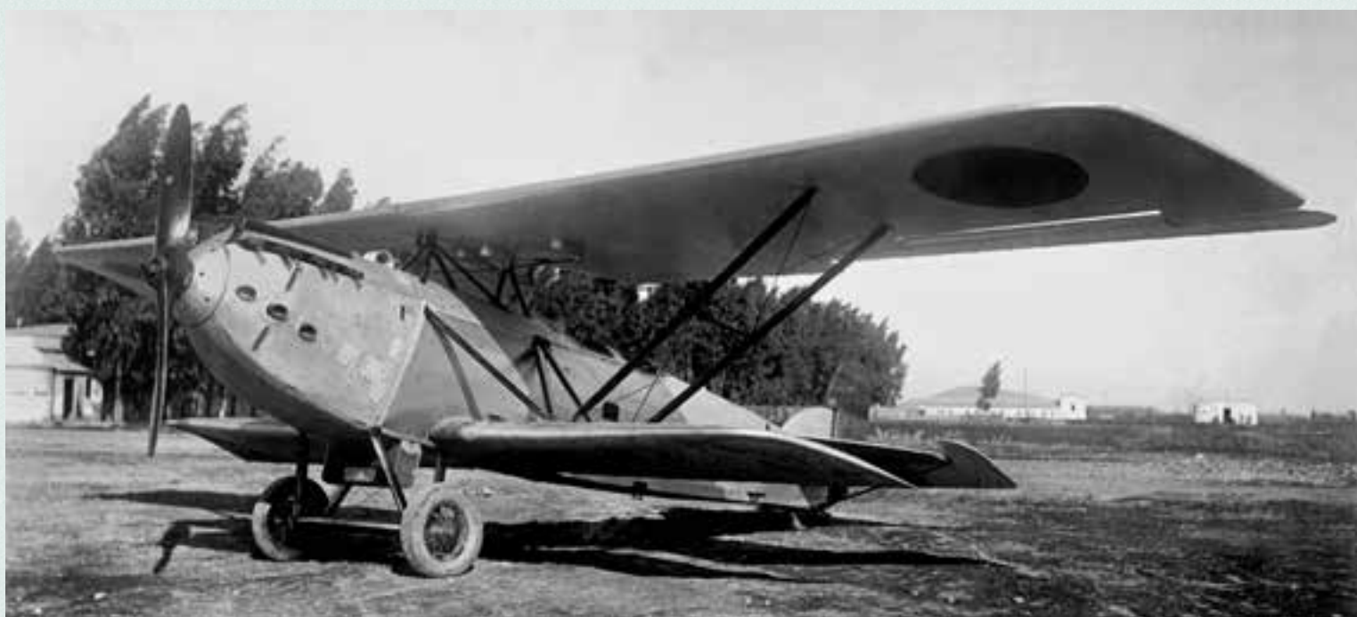
Esta fotografía fechada el 19 de enero de 1933 permite apreciar con claridad como el ala superior del R.III estaba unida directamente al fuselaje con seis riostras en total, cuatro unidas al larguero anterior y dos al larguero posterior.
