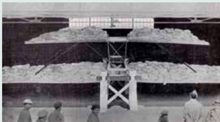
Ensayo de las alas del Loring R.III. Nótese que están en posición invertida, de manera que los sacos aplican el efecto de la sustentación con el correspondiente factor de carga.
