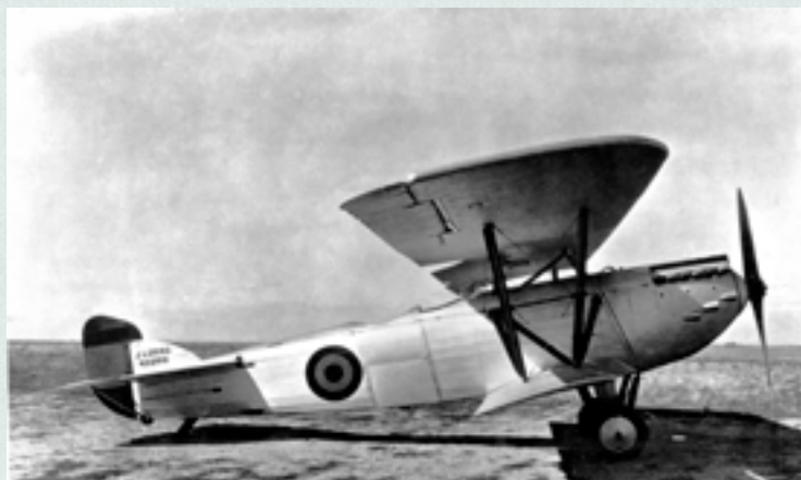
Uno de los cuatro primeros Loring R.III salidos de la fábrica de Carabanchel Alto.
