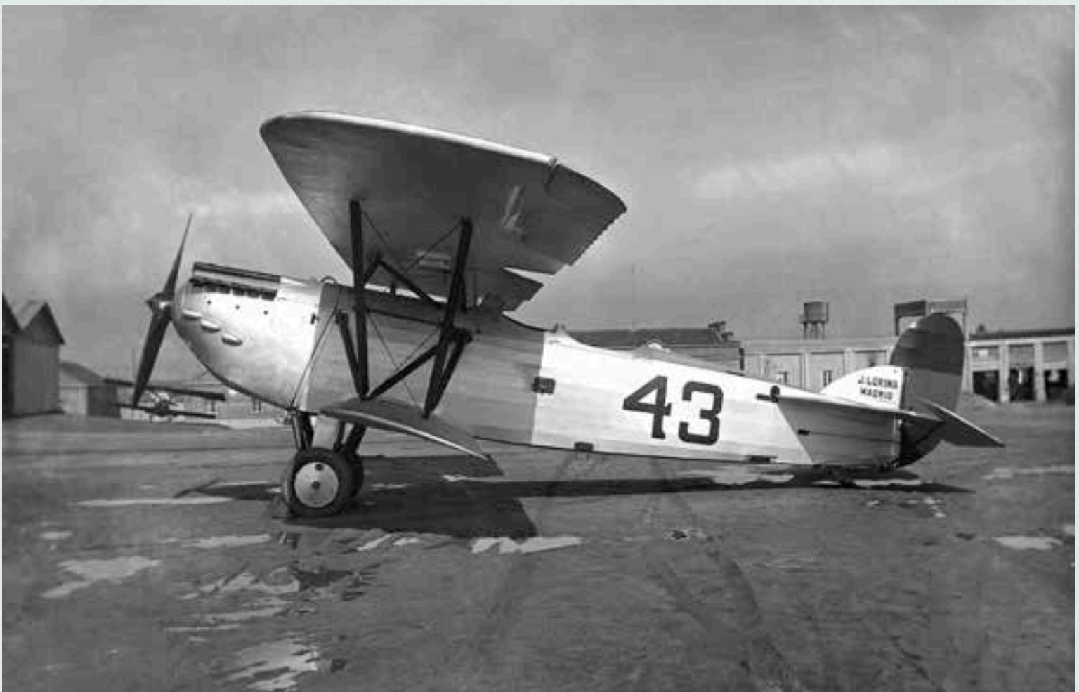
El Loring R.III n.º 43. Obsérvese el aumento de tamaño del mando de dirección. Sin duda se encontró necesario incrementar su superficie en todos los aviones a partir de los datos obtenidos en las pruebas en vuelo.
