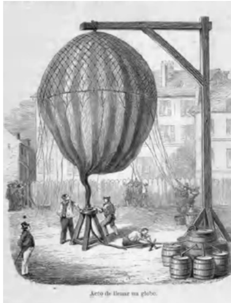
Inflado de un globo de hidrógeno producido en las cubas. LA AMENIDAD 24 MAYO 1884.
