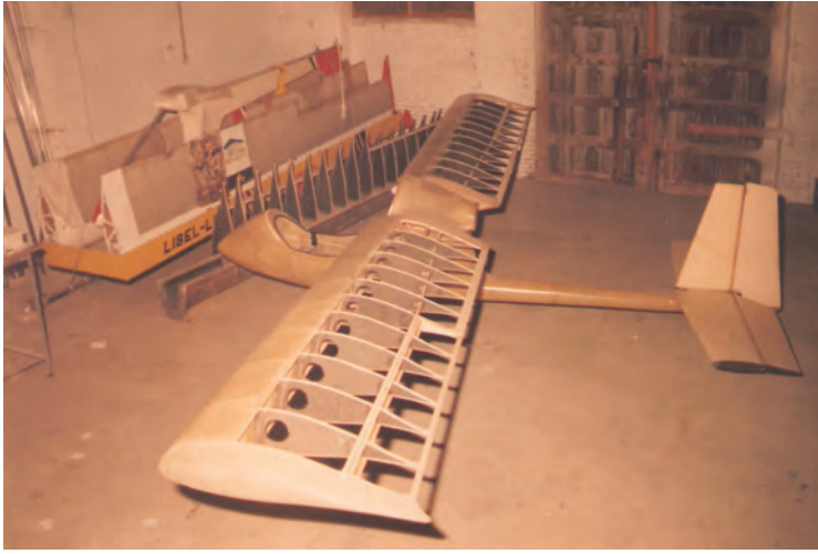
Vista del ultraligero Cases M-8, a falta de entelado, en el interior de la planta baja utilizada para su construcción. En segundo plano puede observarse desmontado el planeador Libel-lula sobre el remolque elaborado ex profeso para su transporte. (Foto: Francisco Cases Masía)
