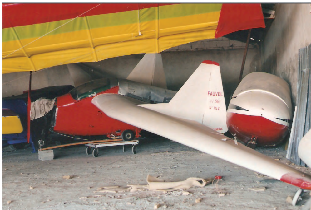
Esta fotografía muestra al Flauvel AV.361 construido por Faustino Cantos durante el mes de octubre de 1998, en el interior de un hangar en el aeródromo de Ontur, Albacete. No deja de ser interesante comprobar el programa de modificaciones que se encontraba en marcha con el propósito de transformarlo en motovelero. Como es evidente, durante este proceso se habían utilizado elementos estructurales procedentes del Flauvel AV.361 matriculado EC-BEU. (Foto: José Miguel Sales Lluch)
