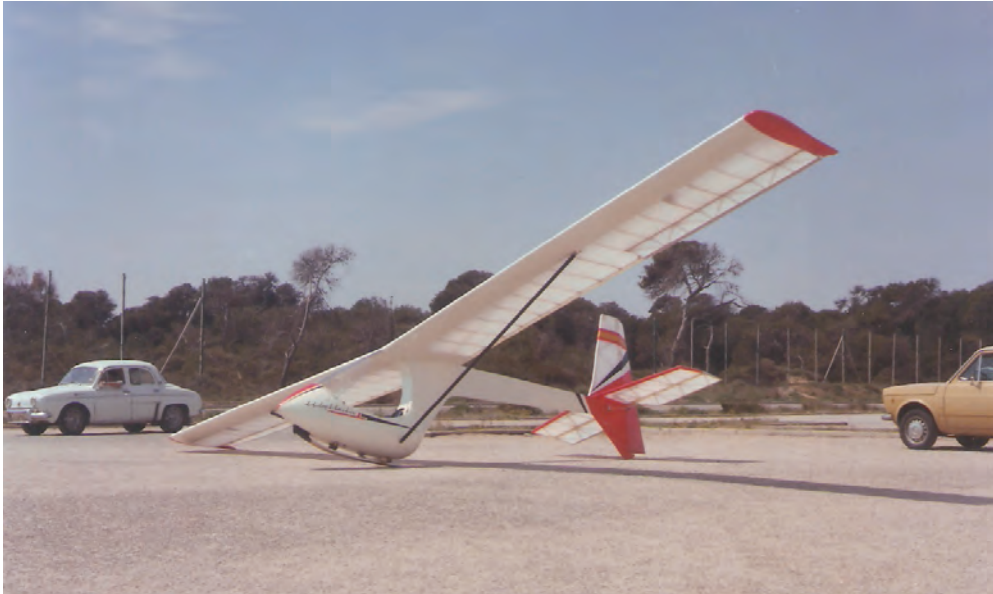
Una de las primeras construcciones de Francisco Cases Masiá: el planeador ligero de 10,5 metros de envergadura Libel-lula, realizado utilizando materiales compuestos durante el año 1978. El diseño de Cases despertó gran interés, llegando a contemplarse la comercialización del modelo en forma de kit por parte de una empresa francesa. (Foto: Francisco Cases Masiá)
