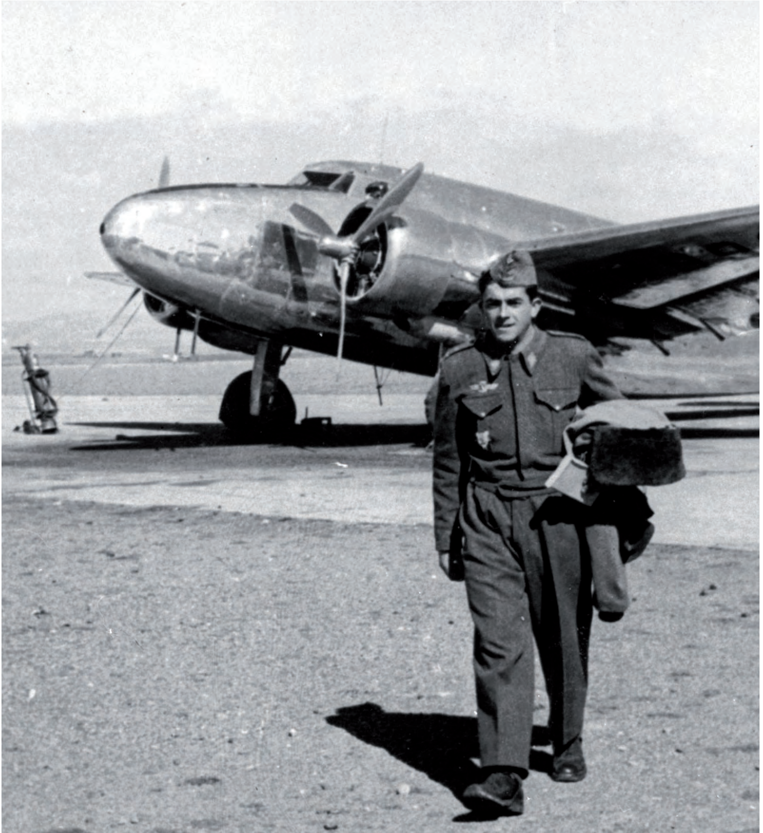
Este "Lodestar", del que por desgracia ignoramos la matrícula, parece que tenía pulidas todas sus superficies externas (SHYCEA)
