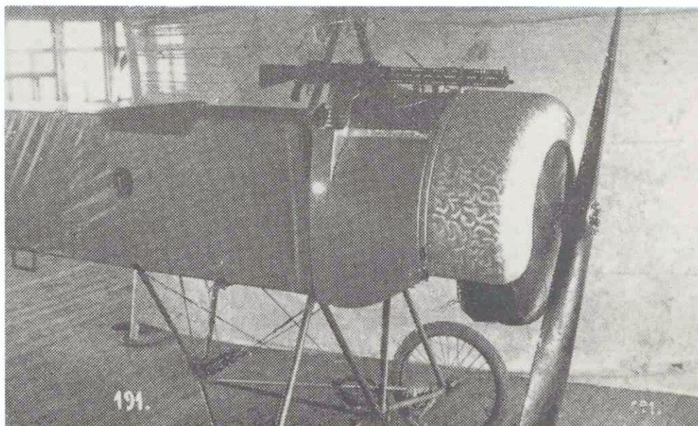
Instalación de ametralladora Parabellum sincronizada sobre monoplano Fokker M 5k/MG. Los aparatos de serie usaron generalmente la ametralladora Spandau
