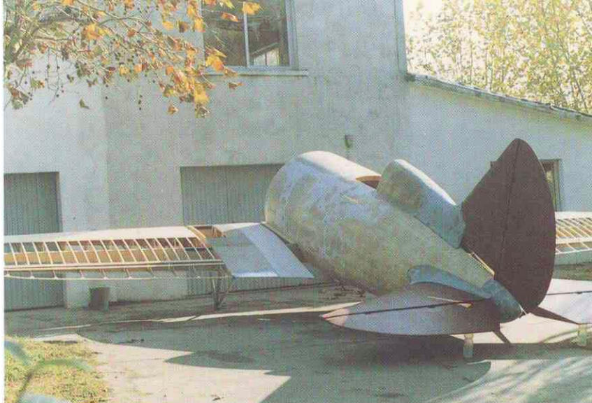
Este aspecto presentaba la reconstrucción del caza I-16 cuando se hizo su primer montaje para acoplamiento de las semialas (Foto J. ABE-LLÁN).
