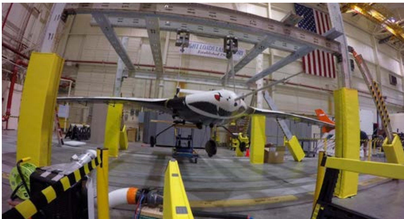
Figura 4. RPA Lockheed Martin X-56 experimentando tecnologías de supresión de flameo en la NASA. (Fuente: https://www.youtube.com/watch?v=7xQJ2sVQrUA&list=PLiuUQ9asub3QuciH4PnkgwJC5P7Ht3IAa )
