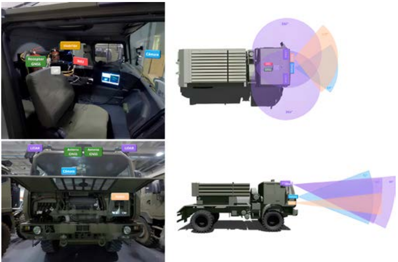
Fig. 3. Arquitectura sensorial del vehículo. A la izquierda, interior y exterior de la parte frontal de un camión automatizado; a la derecha, los campos de visión horizontales y verticales de todos los sensores exteroceptivos instalados. (Fuente: Centro de Automática y Robótica)
