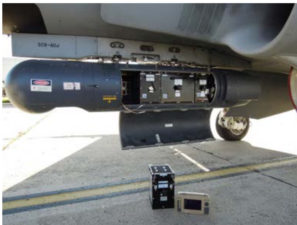
Fig. 1. Integración del ROVER en el pod LITENING del EF-18 realizada por el EA. (Fuente: https://www.youtube.com/watch?v=Xk8dnX6ZFj0 )
