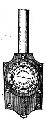
El curvimetro se reduce, segun se vé en la figura, en escala mitad de la natural, á una caja metálica formada por dos placas unidas por tornillos, y que contiene en su interior un sistema de ruedas dispuestas de tal modo que están en relacion por un lado con una aguja indicadora exterior, y por otro con una ruedecilla dentada que sirve para recorrer la línea curva que se quiere medir en el mapa, y que sobresale por la parte inferior de la caja del instrumento.
