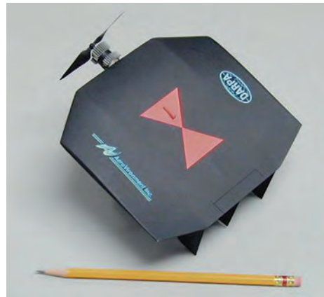
Figura 5.1.2-3. Ejemplo de Micro-UAV: el «Black Widow», de la empresa AeroVironment Inc (Fuente: AVInc).
