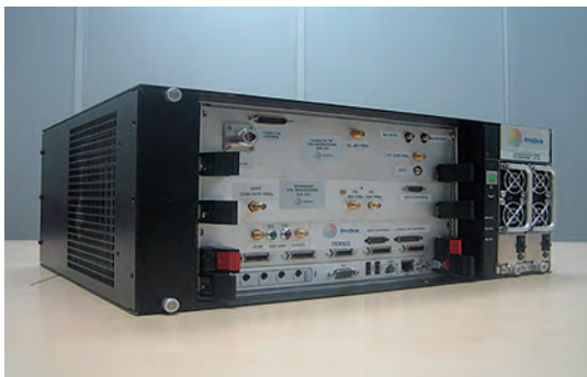
Figura 5.1.6-1. Prototipo del Programa TERSO (Terminal Radio Software). Plataforma SDR española de entrada al Programa ESSOR. (Fuente: Ministerio de Defensa).
