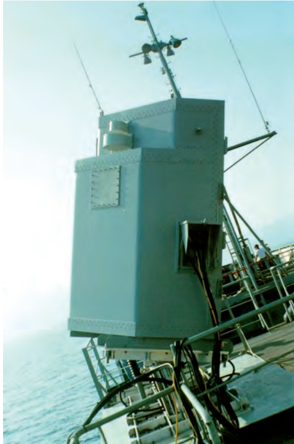
Figura 3.3-1: Antena ECM prototipo (Sistema ALDEBARÁN) (Fuente Ministerio de Defensa).
