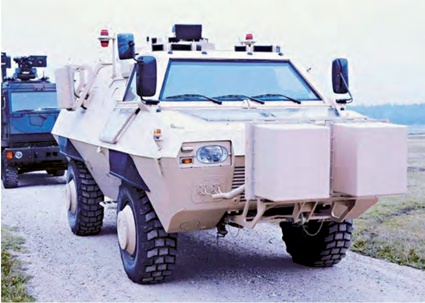
Figura 5.18-4. Sistema C-IED «Ambush Terminator» de Rheinmetall, instalado sobre un vehículo blindado TM 170. Las antenas emisoras están situadas en la parte frontal y en los laterales del vehículo (Fuente: Rheinmetall Defence).
