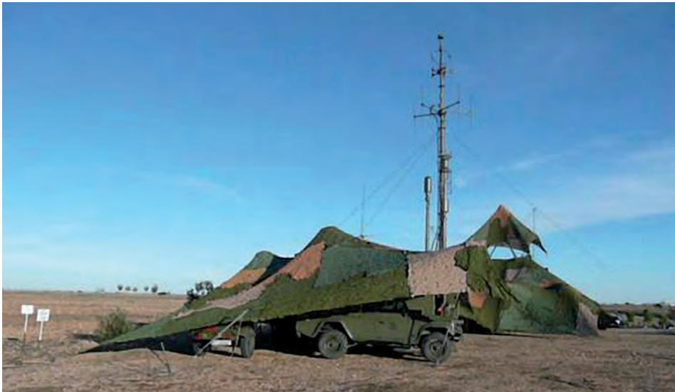
Figura 4.4-5. Estación básica de los Subsistemas de Telecomunicaciones y No Telecomunicaciones del sistema GESTA cubierto con redes miméticas (Fuente: Ministerio de Defensa).
