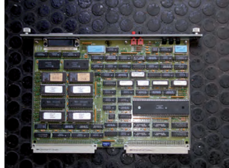
Figura 4.2-2. Procesador general de comunicaciones (Fuente INDRA).
