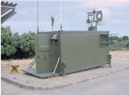
Figura 4.1-11. Sistema LIBRA de medida RCS de plataformas navales (Fuente Ministerio de Defensa).
