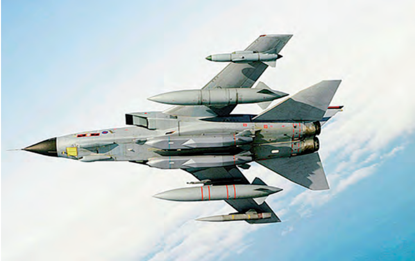
Figura 5.1.8-3. Misiles de crucero «Storm Shadow» en un Tornado GR.4 (son los dos misiles situados debajo de la parte central del fuselaje). (Fuente: MBDA).
