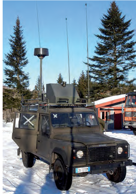
Figura 5.1.3-6. Fotografía del Interceptor/Perturbador móvil del MEWSG de la OTAN (Fuente: JANE's Information Group).
