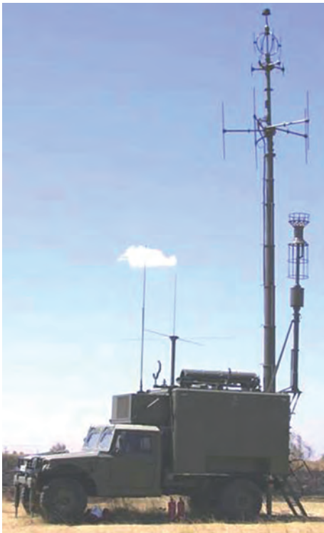
Figura 4.4-3. Estación básica Subsistema de Telecomunicaciones del Sistema GESTA (Fuente Ministerio de Defensa).
