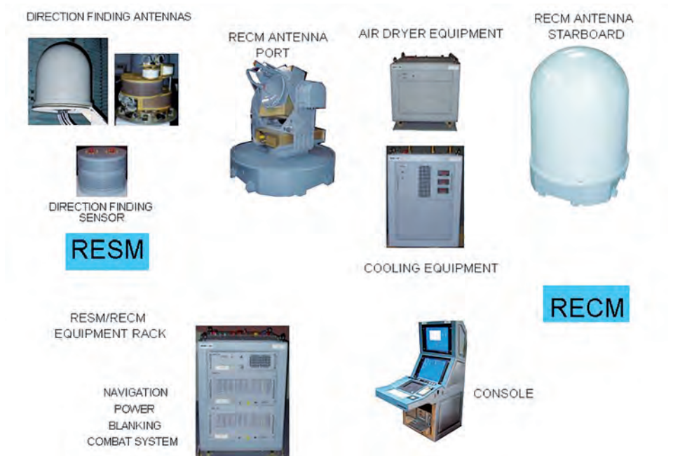
Figura 4.4-6. Equipos del Sistema de GE RIGEL (Fuente: Ministerio de Defensa).
