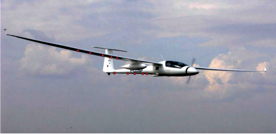
Figura 5.1.3-2. Ejemplo de integración de antenas en una plataforma aérea. Los puntos rojos señalan la posición de los elementos de la antena, situados a lo largo de un ala y del fuselaje de un planeador a motor de tipo Stemme. La antena es un array interferométrico para la geolocalización de emisores (Fuente: [16]).
