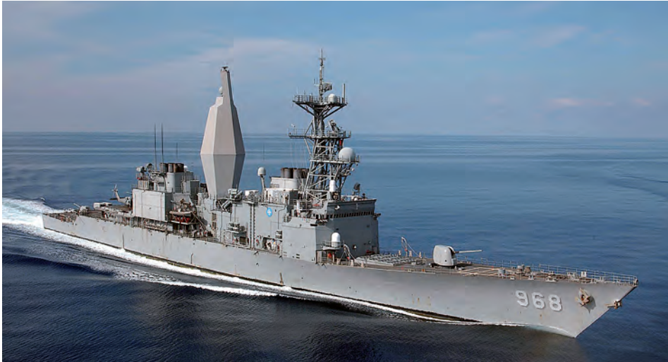
Figura 5.1.3-3. Imagen del destructor USS Arthur W. Radford, en la que se aprecia el mástil integrado AEM/S (es la gran estructura poliédrica situada a popa del mástil convencional). (Fuente: U.S. Navy/Summer M. Anderson).
