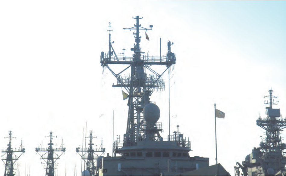
Figura 4.4-7. Antenas del Subsistema ESM de GE RIGEL instaladas en los mástiles de una fragata FFG (Fuente: Ministerio de Defensa).
