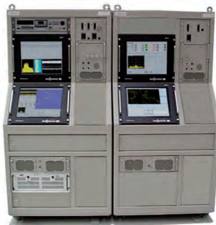
Figura 4.1-8. Consola de presentación del Sistema REGULUS (Fuente INDRA).
