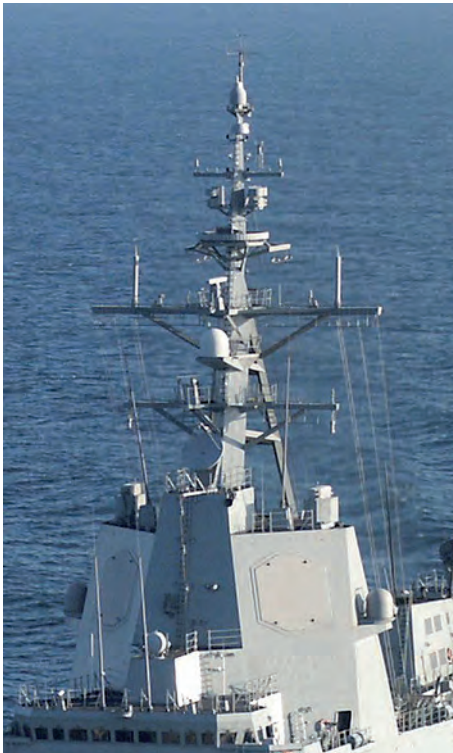
Figura 4.1-2. Detalle del Mástil. Sistemas ALDEBARAN y REGULUS instalados en la F-100 (Fuente Ministerio de Defensa).
