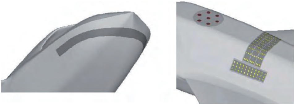
Figura 5.1.3-1. Ejemplo de antenas conformables en una aeronave. Izquierda: antena de banda ancha para enlace de datos tácticos. Derecha: antenas para comunicaciones por satélite (Fuente: [17]).
