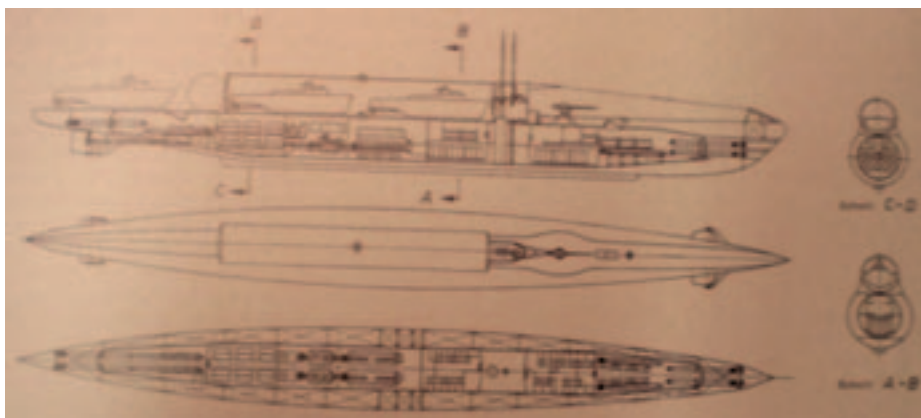
Dibujos seccionados del diseño del U-Boattype III (mod.), mostrando el hangar estanco para el transporte de dos pequeñas lanchas torpederas. (Foto: Harald Fock)
