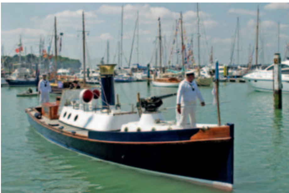
La Steam Pinnace 199 preservada en el National Museum of the Royal Navy. Puede verse un cañón de tipo rápido Hotchkiss de 47 mm. (Foto: National Museum of the Royal Navy)
