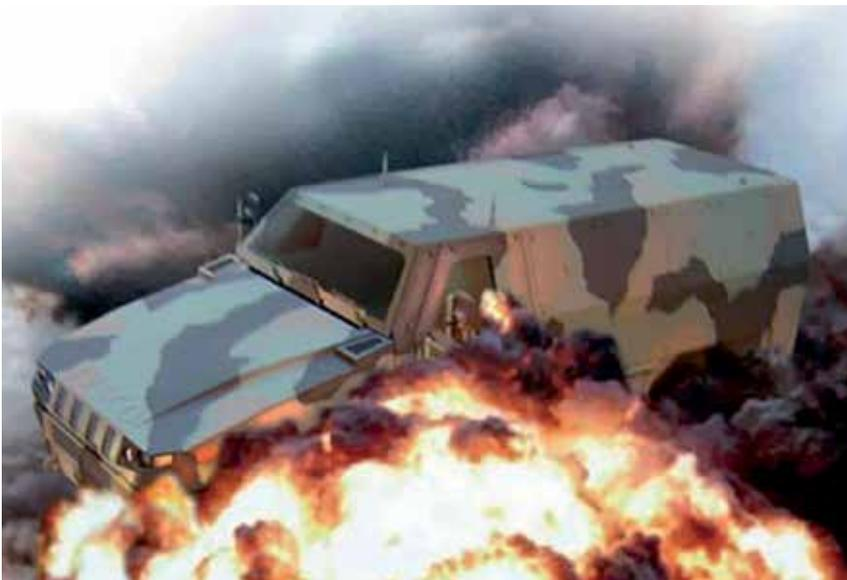
*Test antiminas efectuado a un chasis «MPV»*
