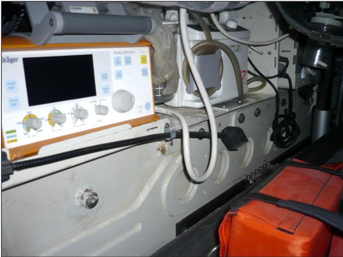
**Figura 6.** Vista de la disposición interna del ventilador, de la bomba de aspiración ubicados en el interior de la pared derecha.
