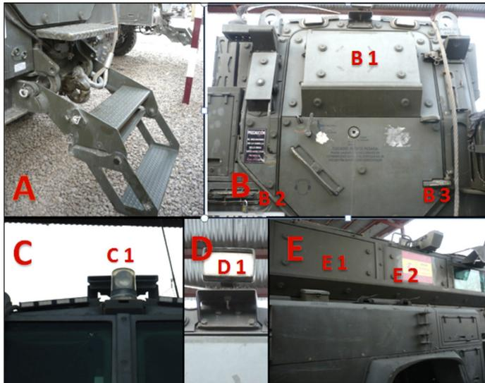
**Figura 2.** Algunas de las particularidades encontradas en el RG 31 versión ambulancia. A: Escalerilla trasera con peldaño abatible. B: Vista trasera del vehículo, B1 ventana trasera blindada, B2 y B3 enchufes eléctricos. C: Dispositivo luminoso, sirena frontales y luces LED. D: Foco trasero. E: Blindaje lateral, E1 y E2: ventanas blindadas. Fotografías de los autores.
