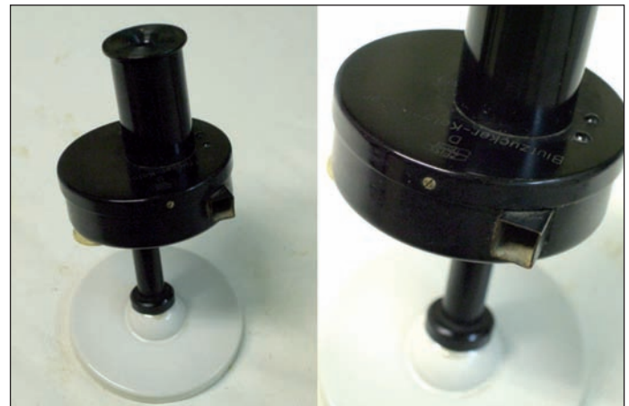
Figura 2. Colorímetro de Zeiss Ikon modelo D (Blutzucker-Kolorimeter) en el que se aprecia la celda para la cubeta de cristal (Flecha). Este modelo tiene el pie de peana.
