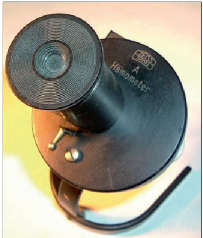
Figura 6. Base del colorímetro mostrando la disposición de los discos transparentes y de la celda para alojar la cubeta (Ver la correspondencia con los esquemas de la figura 4).
