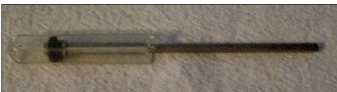
Figura 5. Cubeta de cristal y varilla metálica para su limpieza
