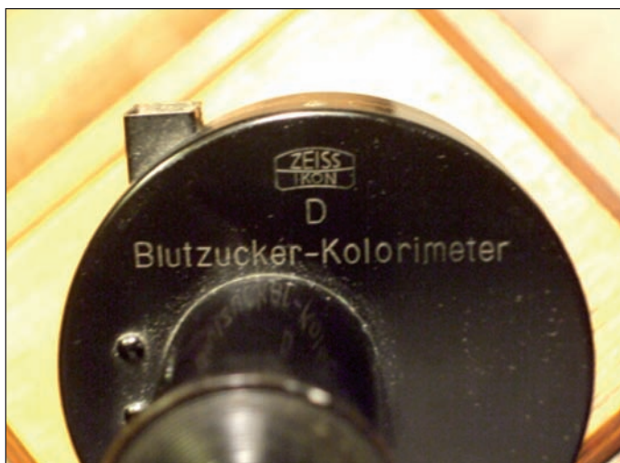
Figura 1. Colorímetro de Zeiss Ikon modelo D para la determinación de la glucemia por el método de Crecellius y Seifert (Blutzucker-Kolorimeter).
