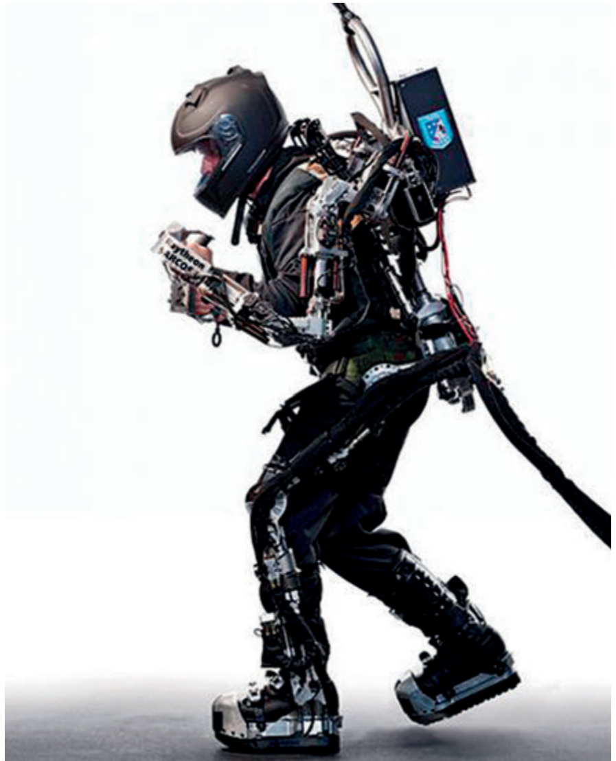
Fig. 1. Modelo XOS2 desarrollado por Raytheon-Sarcos. (Fuente: www.loyalkng.com ).
