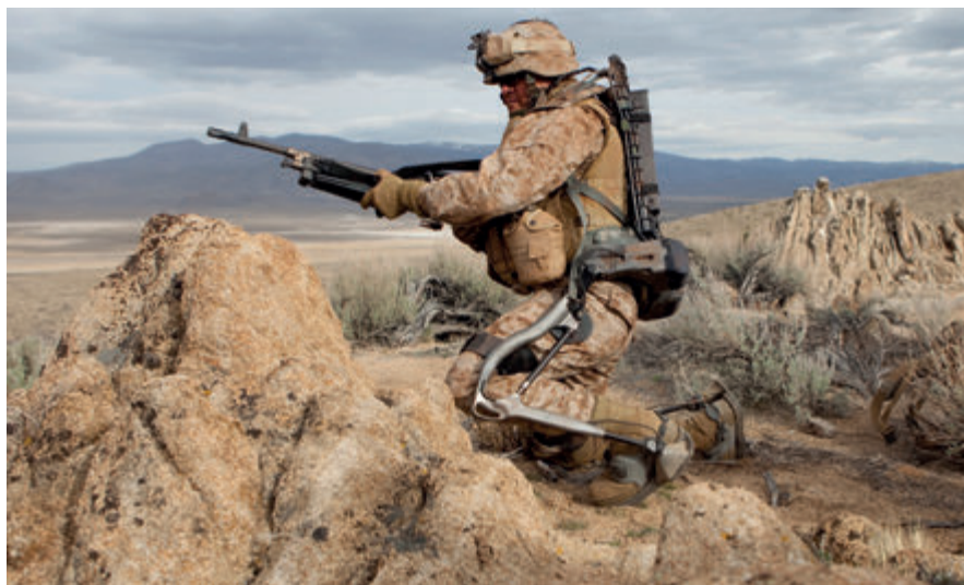
Fig. 2. Modelo HULC, de Lockheed Martin. (Fuente: www.agarriverau.disegnolibre.org ).
