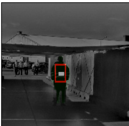
Fig. 4. Imagen de visible fusionada con milimétricas de una persona a 15 m ocultando un cinturón de explosivos. [2]
