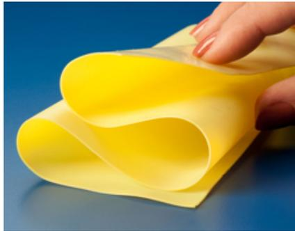
Fig. 3. Aerogel flexible desarrollado en la NASA. (Fuente: www.rdmag.com).
