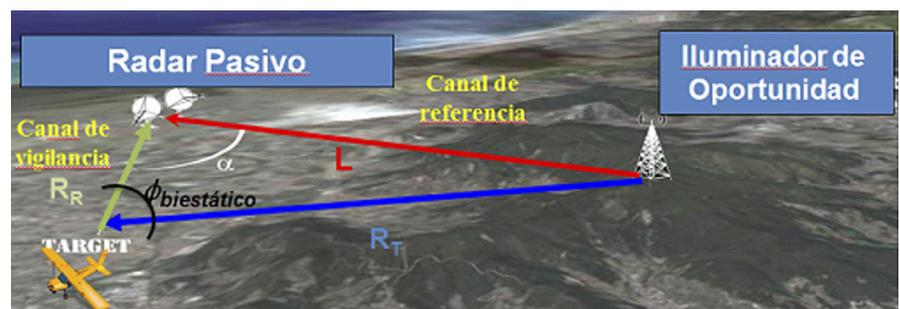
Fig. 1. Geometría de un radar pasivo biestático.
